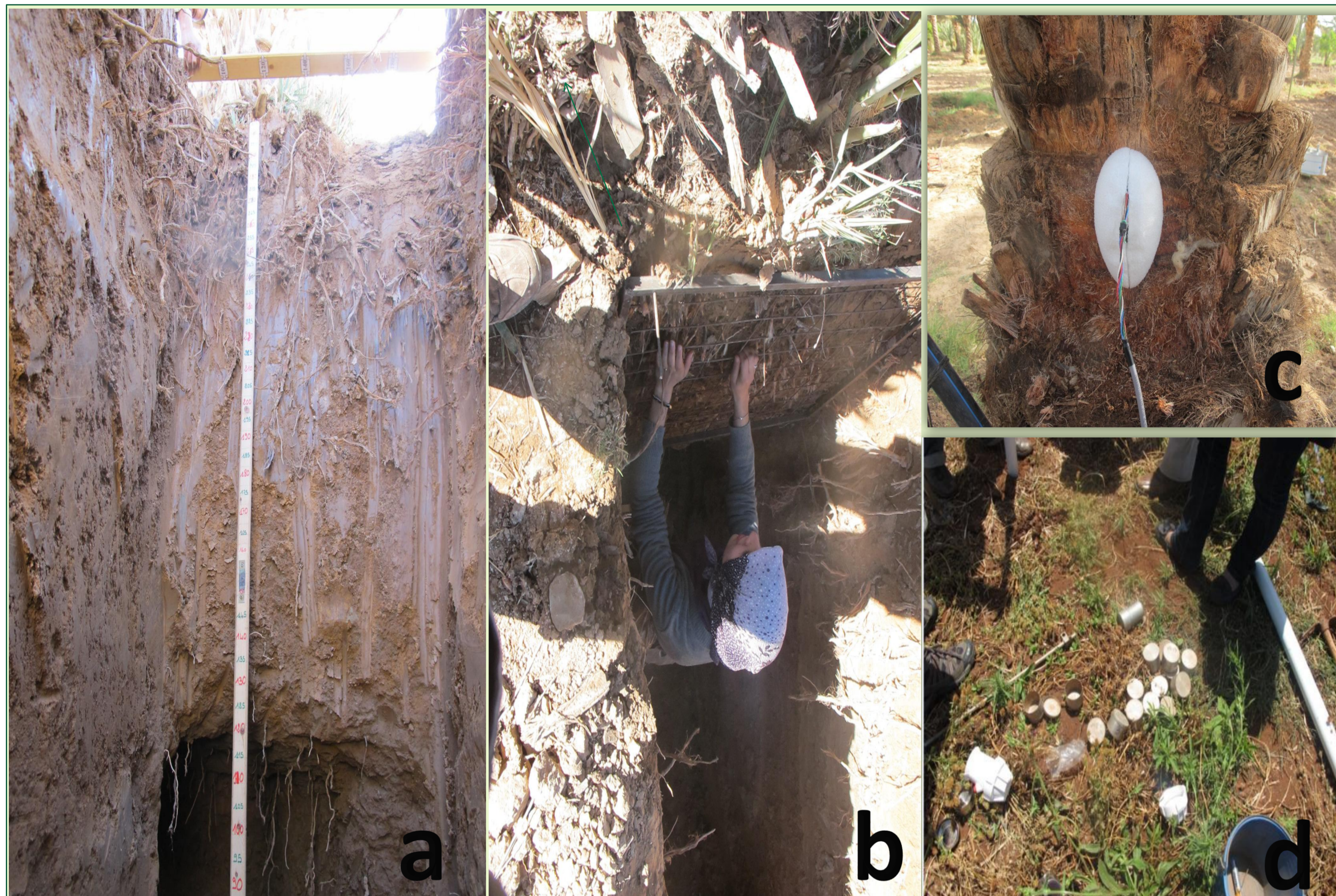
(a)(b) Characterisation of roots profil (c) Transpiration measurement (d) Soil moisture monitoring
